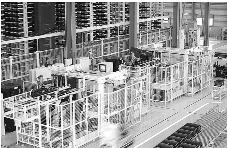
24時間体制で鋼材の自動切断ができるFAセンター
